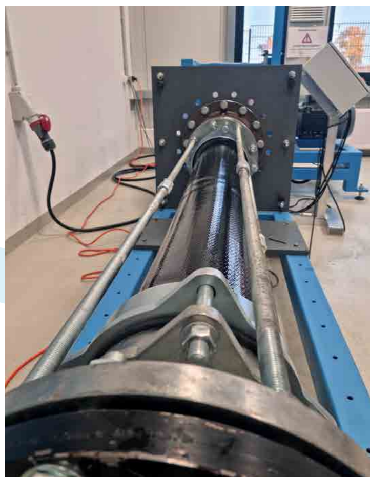
Bild 1: Druckrohr-Lastwechsel-Test-Anlage (DLT) • Quelle: s+k
